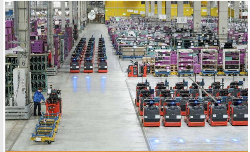
Brennstoffzellen im Intralogistik-Einsatz: mit Wasserstoff betriebene Routenzüge im BMW Group Werk Leipzig. (Foto: BMW)
